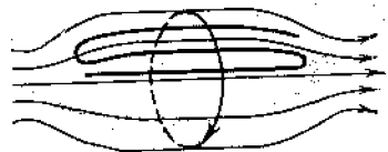
Рис. 2.5. Осевая линия траектории частицы в поле с магнитными пробками
