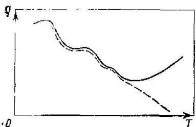
Рис. 1.10. Зависимость интенсивности линейчатого излучения от температуры для углеродной плазмы (штриховая кривая) и полное излучение (сплошная кривая)
